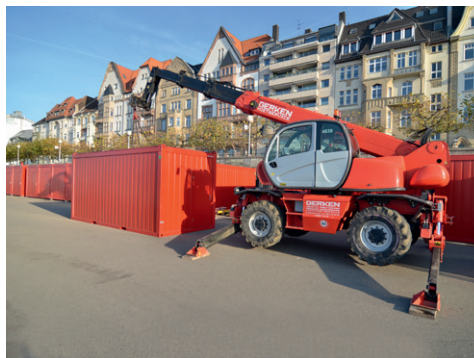
Leistungsfähige Transportfahrzeuge liefern die Container an, für schwierige Einsätze stehen Rotor-Teleskopstapler zur Verfügung.
